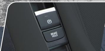
Freno de estacionamiento electrónico (EPB) con función Break Hold
