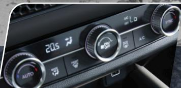
Climatizador digital doble zona con ajuste automático de temperatura
